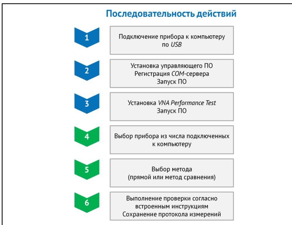
Последовательность действий при работе с *VNA Performance Test*:
