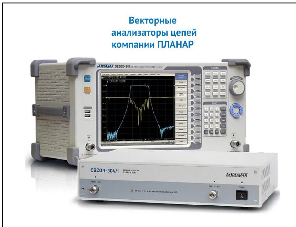
Векторные анализаторы цепей производства компании ПЛАНАР разделены на четыре серии в зависимости от их назначения, технических характеристик и функциональных возможностей: КОБАЛЬТ, ОБЗОР, КОМПАКТ и САВАН.
