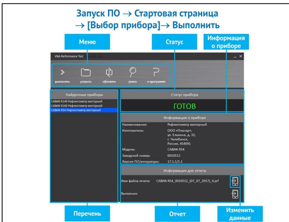
**Для запуска процедуры проверки необходимо выбрать прибор из числа подключенных и нажать кнопку «Выполнить».**
