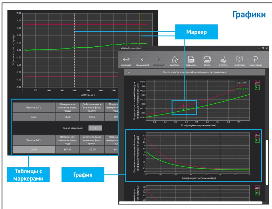
Результаты измерений могут быть представлены в виде **графиков**. Данные с графиков можно считывать при помощи маркеров, визуально по сетке с делениями или относительно расположения линии допуска. Все графики можно масштабировать.
